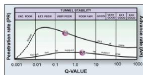
Obr. 1 Metoda Q-systém pro klasifikaci stability výšbu a posudků jeho výkonu je zde použita k vyhodnocení relativní účinnosti ražby tunelů pomocí TBM, s výjimkou přírodních a tvrdých hornin PR a rychlosti postupu AR. Fig. 1 The Q-system method of classifying tunnel stability and support needs is used here to indicate the relative efficiency of driving tunnels by TBM, with curves to suggest PR (penetration rate) and AR (advance rate)
